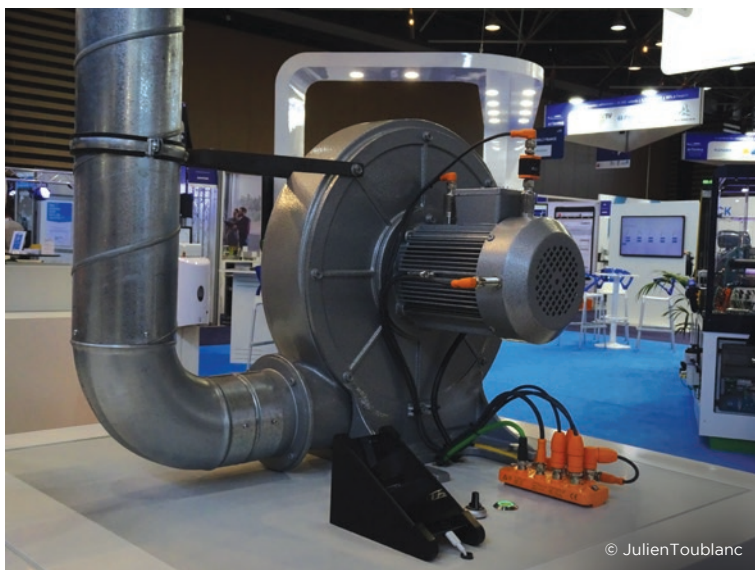
Présentation d'un capteur de vibrations, fabriqué par la société allemande ifm electronic, au salon Global Industrie 2021 à Lyon.
